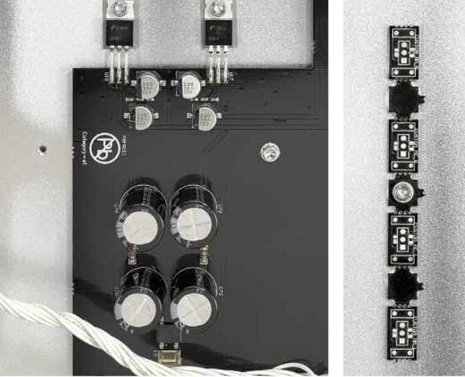
Oben links: Bewährtes Konzept: Die LM317 & LM337 Spannungsregler sind einstellbar und zeichnen sich durch extreme Rauschfreiheit aus
