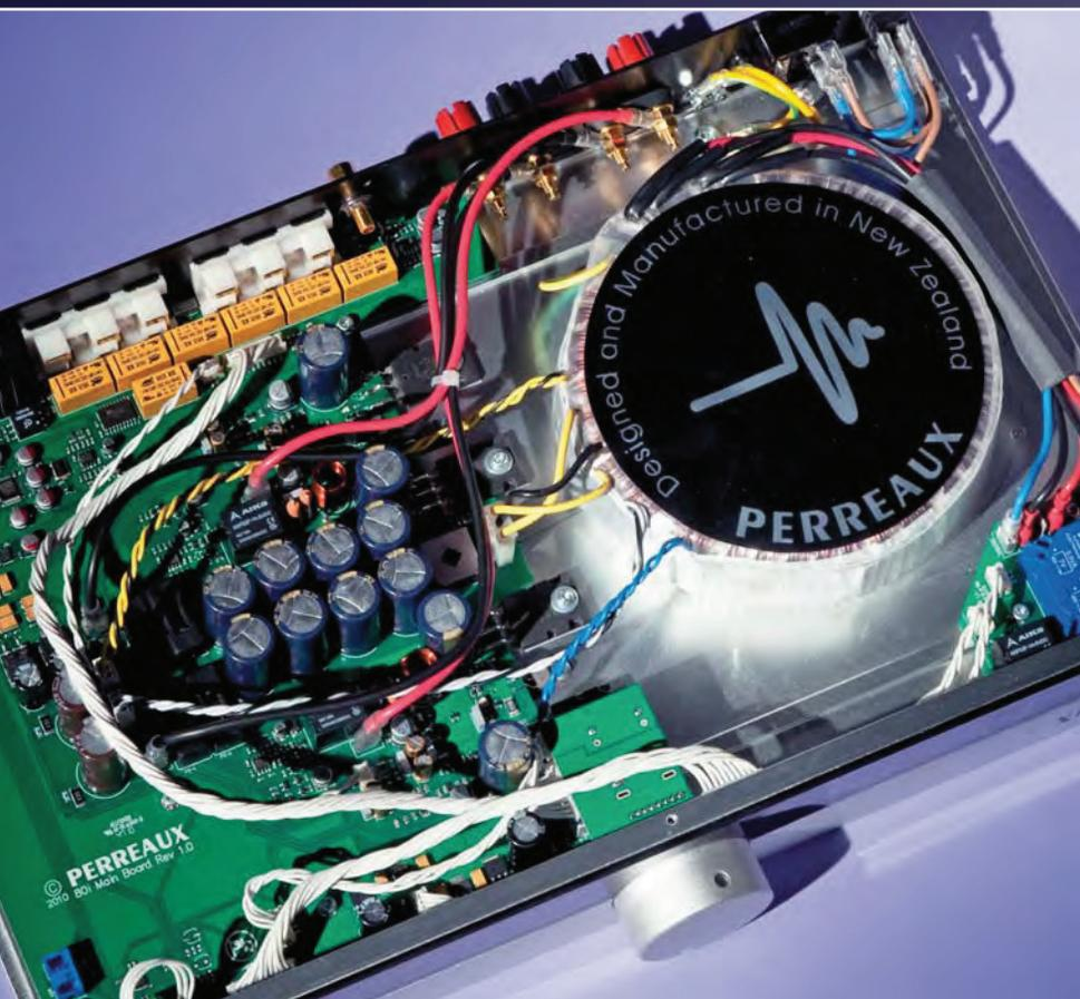
De façon inhabituelle, l'ensemble des composants est solidaire du capot supérieur en aluminium qui agit comme un radiateur et évacue la chaleur des transistors MosFet de puissance.
